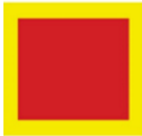
Figura 6-4 Sinalização horizontal dos extintores (símbolo)
