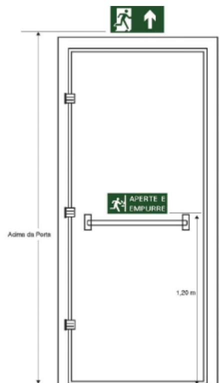
Figura 6-2 Sinalização de saída (locação), altura mínima 1,80 m
