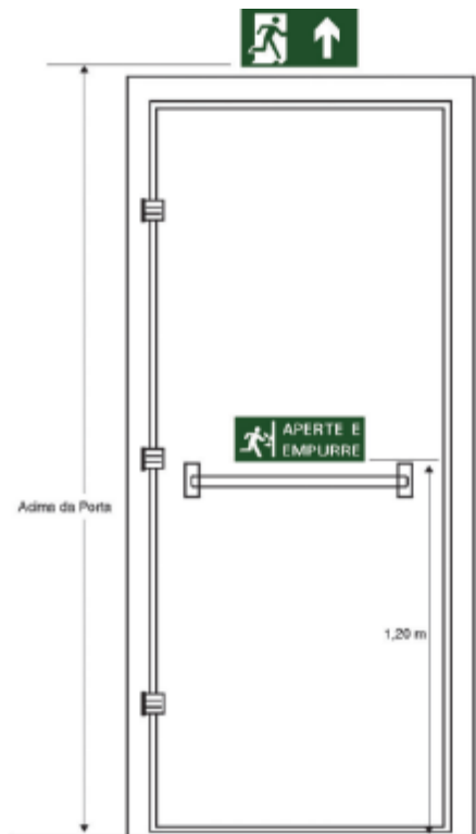
Figura 6-2 Sinalização de saída (locação), altura mínima 1,80 m
