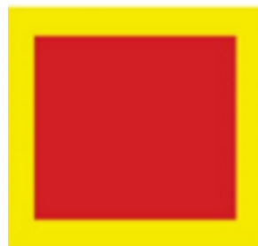
Figura 6-4 Sinalização horizontal dos extintores (símbolo)
