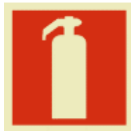
Figura 6-3 Sinalização vertical dos extintores (símbolo)
